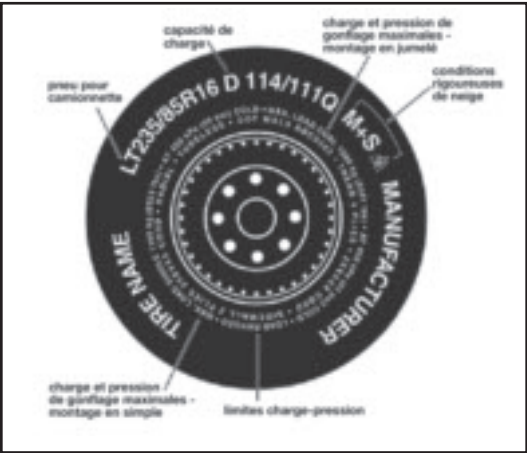
Illustration 4 : Inscriptions types d'un pneu pour camionnette
